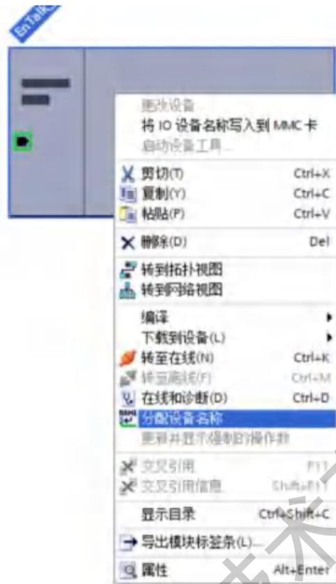
弹出“分配 PROFINET 设备名称”对话框，在“网络中的可访问节点”下点击更新列表（EnTalk 设备正确连接在网络里）即可访问出 PROFINET 网络里的各个节点；选中更新列表的节点，点击“分配名称”将组态的 PROFINET 设备名称：“entalk”写入网络节点中；写入成功后 PROFINET 设备名称更新为“entalk”，状态为“正确”；关闭该对话框；重启网关后设备名称有效。
